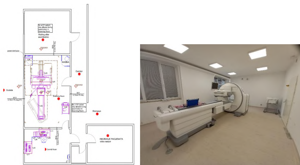
Slika 1: a) Tlocrt prostorija u koje je na kraju postavljen SPECT/CT uređaj, s popratnim prostorijama; b) slika postavljenog SPECT/CT uređaja u prirodnom staništu
